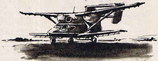
Polski M-15 „Belphegor” — uniwersalny, nowoczesny samolot rolniczy z silnikiem odrzutowym
